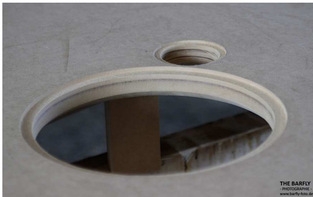
Innenversteifungen (der große Ausschnitt ist für einen 30er!)
